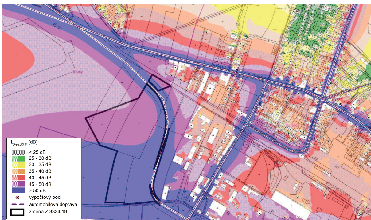
Obr. 34. L_{Aeq} [22 až 6 hod], stav po změně, izofony ve výšce 4 m nad terénem
